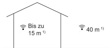
Mit Casambis Mesh Network Technologie agiert jede Steuereinheit auch als ein Repeater. Durch den Einsatz mehrerer Casambi Units können größere Reichweiten erreicht werden.
