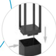
La tête de luminaire scellée peut être remplacée rapidement et en toute sécurité sous la forme d'un module complet.
