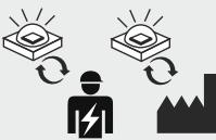
Die Lichtquelle dieser Leuchte darf nur vom Hersteller oder einem von ihm beauftragten Servicetechniker oder einer vergleichbar qualifizierten Person ersetzt werden. DIN EN 60598-1 / IEC 60598-1
