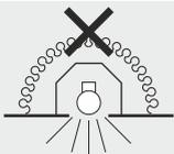
Nicht zur Abdeckung mit Wärmedämm-Material geeignete Leuchten!
