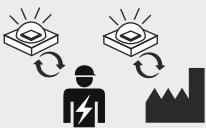
Die Lichtquelle dieser Leuchte darf nur vom Hersteller oder einem von ihm beauftragten Servicetechniker oder einer vergleichbar qualifizierten Person ersetzt werden. DIN EN 60598-1 / IEC 60598-1
