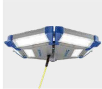
Gehäuse Aluminium / Kunststoff, Abdeckung klares Polycarbonat mit Linsenoptik, abnehmbare Zuleitung mit Netzstecker und Potentiometer, stufenlos dimmbar, inkl. Adapter für DIN-Zapfen-Aufnahme nach DIN 14640 mit der Möglichkeit einer geraden oder 30° geneigten Montage, inkl. Transport-Husse
